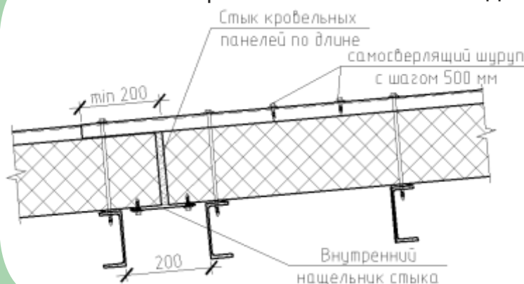
Рис. 7. Стык кровельных панелей по длине
