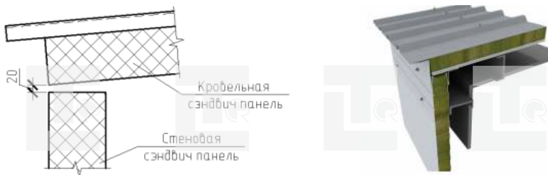
Рис.5. Стык стеновых и кровельных сэндвич-панелей на свесе
